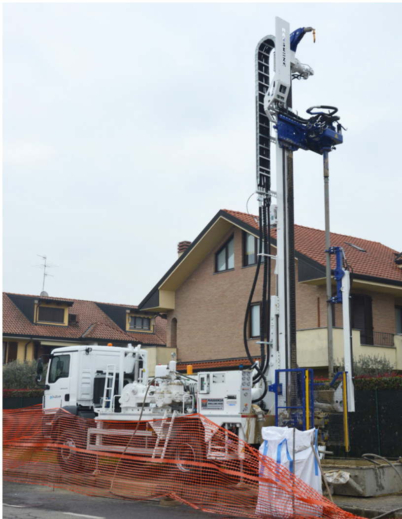
Caricatore aste con braccio Pipe loader Chargeur de tiges Bohrgestänge-lader Cargador de barras Автопогрузчик штанг
