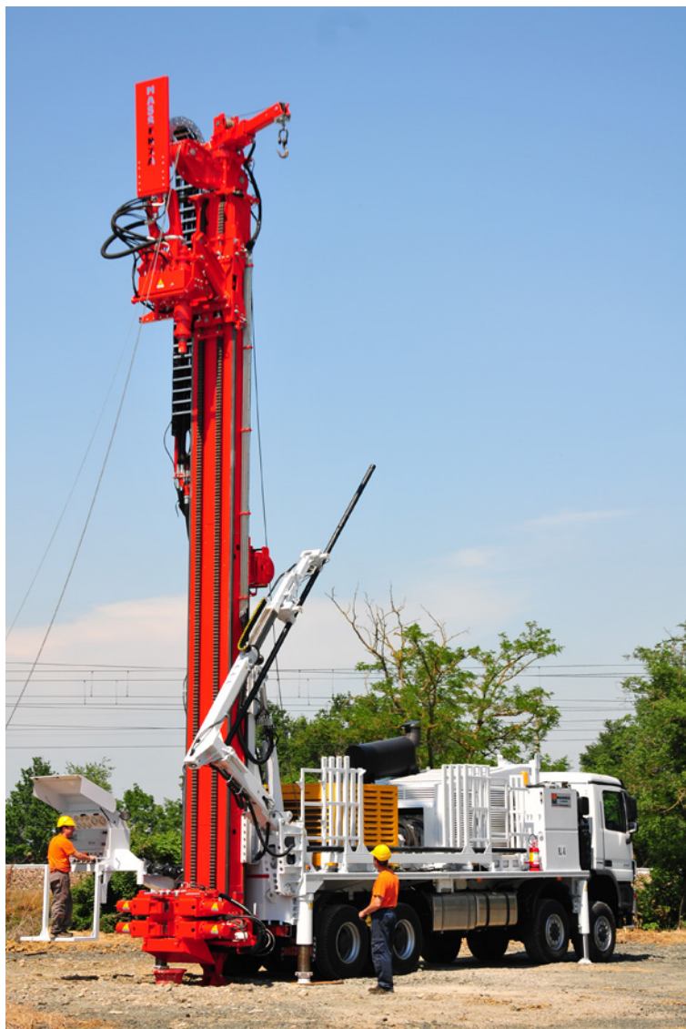
Caricatore aste con braccio Pipe loader with arm Chargeur de tiges avec bras Bohrgestänge-lader mit arm Cargador de barras con brazo Манипулятор подачи штанг
